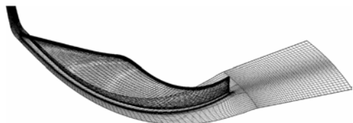
图 5 Krain4 叶轮计算域网格 Fig. 5 Computational domain grid of Krain4 impeller
